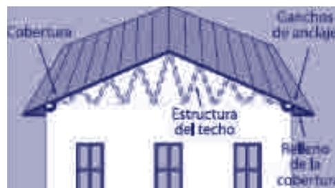
En zonas expuestas a vientos fuertes, a fin de evitar el ingreso de corrientes de aire que puedan levantar la cobertura y destruir el techo, se recomienda cerrar las aberturas existentes bajo las coberturas y techos con mampostería, muro u otro material. Esta medida
