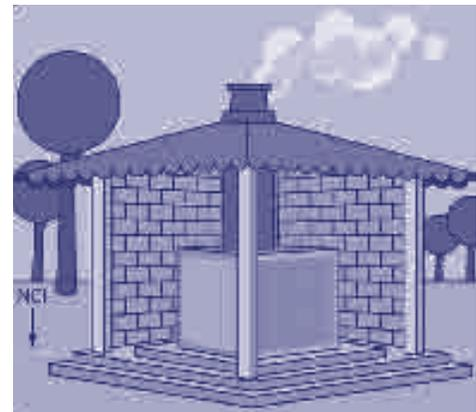
Ante inundaciones, se recomienda elevar la losa del suelo o colocar un muro perimétrico para evitar el ingreso de agua. Así mismo, los desechos patógenos deben estar protegidos mediante cercados u otros para evitar el acceso animal o humano, y herméticamente cerradas las fosas u otros.
