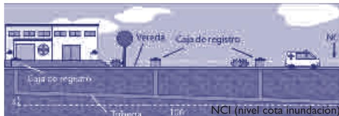
Para evitar la penetración de las aguas pluviales producto de inundaciones y evitar la saturación del sistema fecal por esta causa, además, se pueden elevar las bocas de los registros albañales por encima de la cota de inundación.
