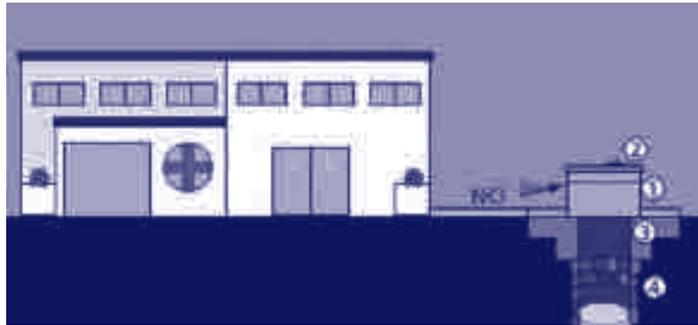
(1) Boca de pozo elevada con respecto al nivel máximo de inundación. (2) Tapa sanitaria para evitar el ingreso de agua contaminada en el pozo. (3) Anillos de concreto armado para reforzar la boca del pozo. (4) Protección de las paredes del pozo (anillos de concreto armado).
